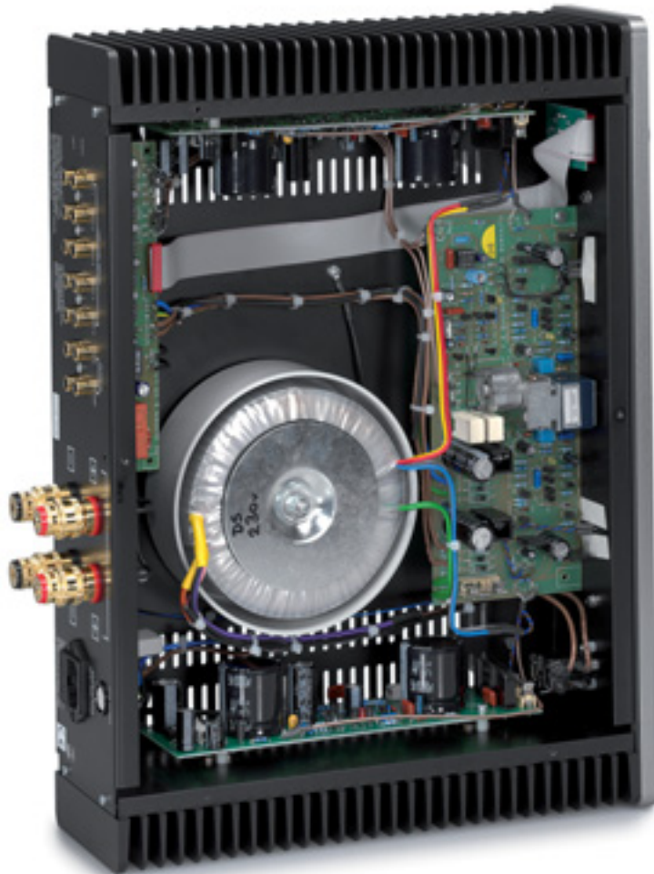
Bilderbuch-Verstärker: Der Trafo ist wirklich „überdimensioniert“ und sorgfältig gekapselt, auch der übrige Aufbau beruht auf sauberem Handwerk
