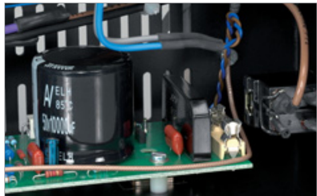
Die zwei in Dual-Mono-Bauweise gefertigten Endstufen besitzen eigene Gleichrichter und Ladekondensatoren
